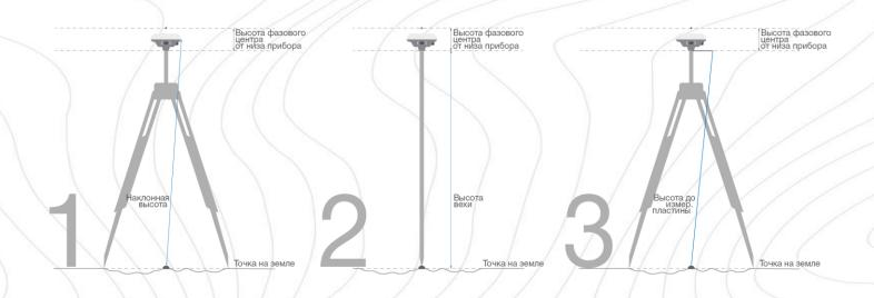
Эти методы используются для определения истинной высоты фазового центра, что позволяет программному обеспечению рассчитывать правильное значение отметки при съемке точек.
